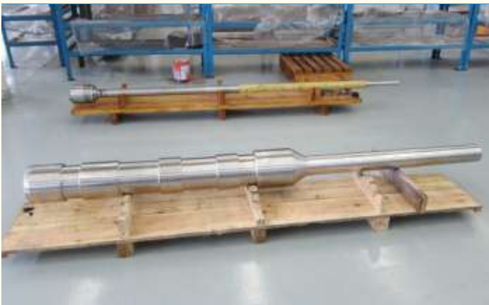
图表 13: ML-B 型 ACP100 小堆控制棒驱动机构密封壳
