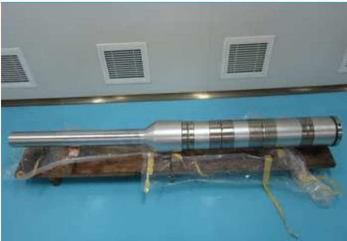
图表 11: ACP1000 控制棒驱动机构密封壳组件
