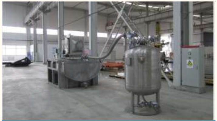
图表 16: 移动式废树脂接收罐
