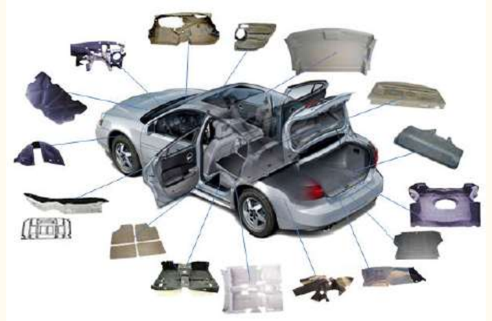
图表 2：公司隔音器在汽车中的应用
