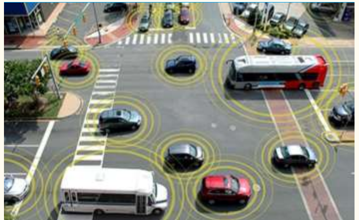
图表 14: V2V 技术可实现相互靠近车辆之间的信息交换，并在可能发生危险时提前预警
