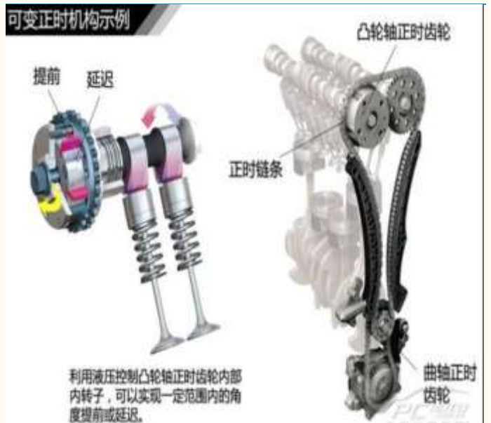
图表 20: VVT 系统机构示例
