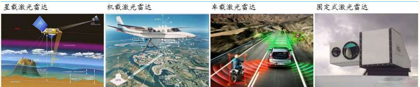
图表 2：激光雷达按照载体不同分为四种类型
