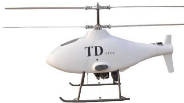
图 12:北理工与中航智联合研发的共轴双旋翼无人机
