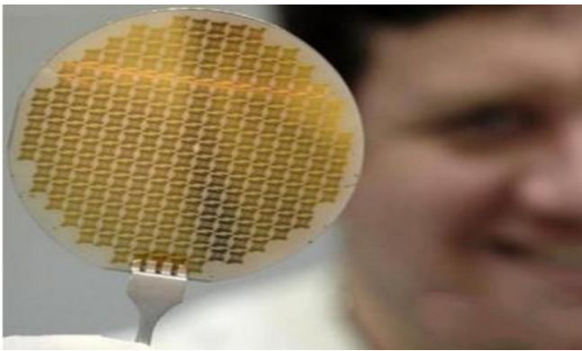
图20: IBM 展示制造的 155GHz 石墨烯晶体管
