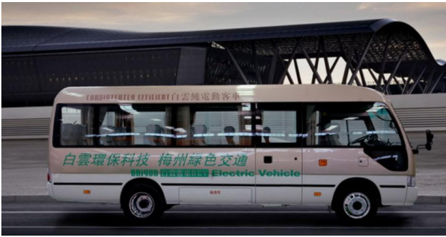
图4 云山汽车 BY6700EV 纯电动客车产品
