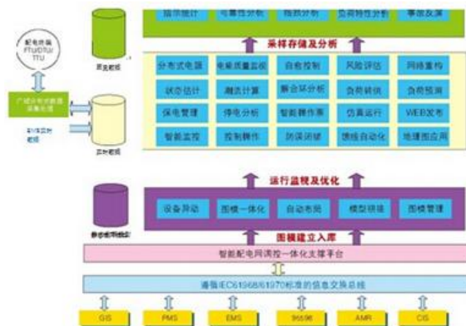
图7：OPEN3200配网自动化管理系统总框架图
