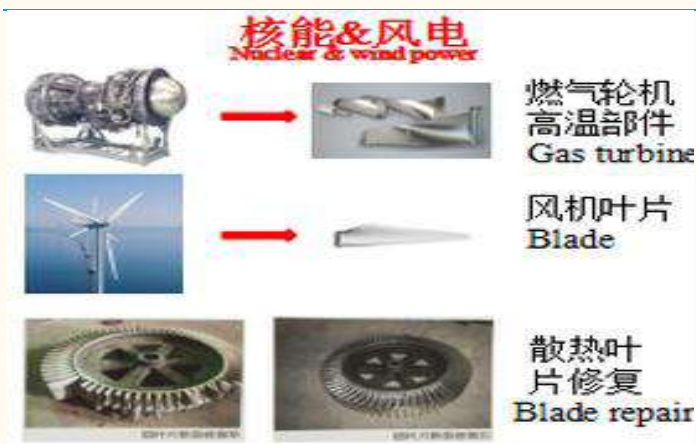
图表 19: 3D 喷焊在核电与风电设备的应用
