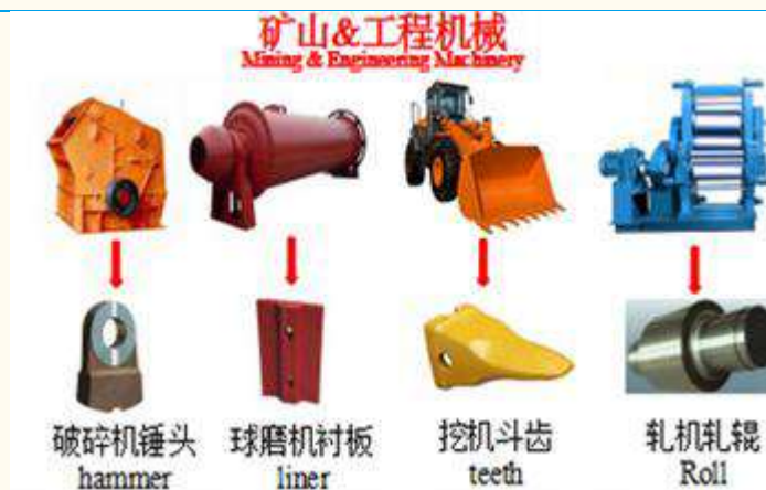
图表 18: 3D 喷焊在矿山与工程机械的应用
