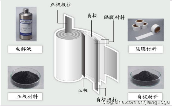
图表5: 锂离子电池结构示意图
