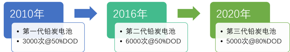
图 15: 公司三代储能电池性能将不断优化
