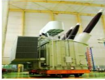
330kV 牵引变压器
