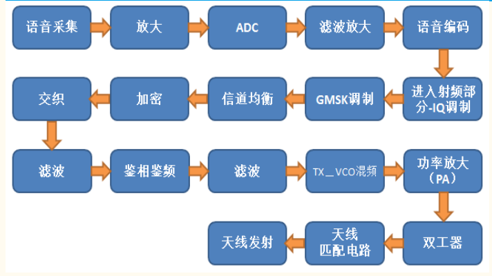
图表 8：手机信号发射流程
