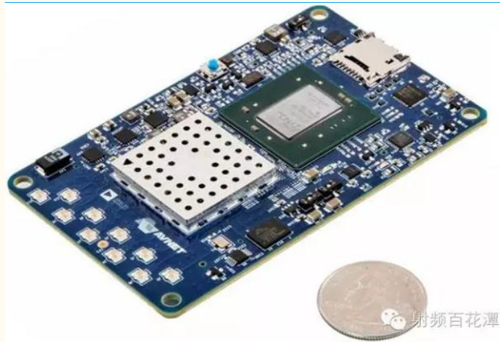
图表 37: 把适合毫米波段的的天线材料和电路印制在电路板上
