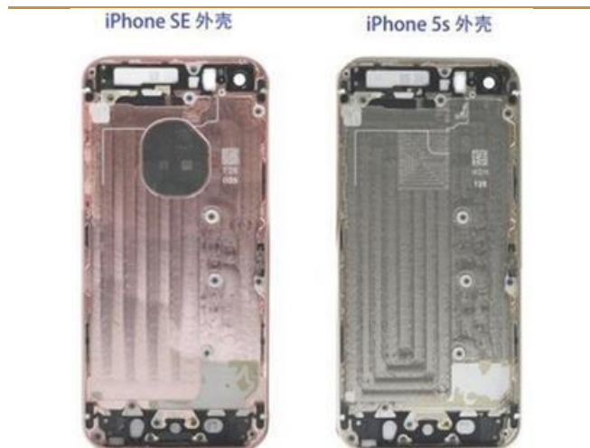
图 23：激光抽刻和金属贴片工艺对比
