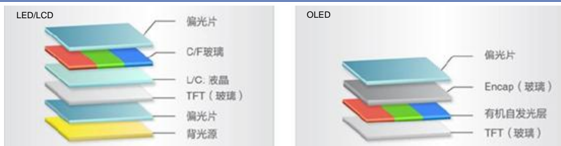
图 16: LED/LCD 与 OLED 结构对比
