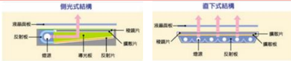
图表9：侧光式、直下式LED背光产品结构示意图
