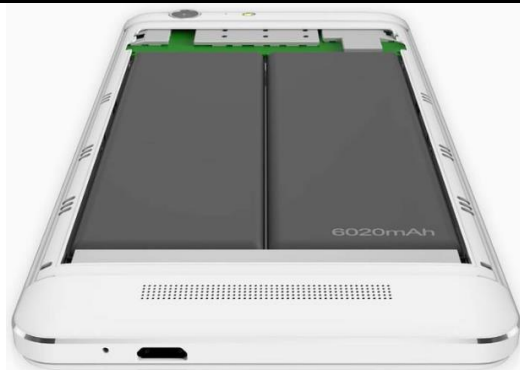
图表 4: 金立 M5 采用双电芯设计
