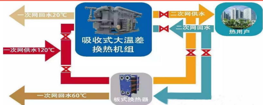
图表 16: 设置于热力站的吸收式换热机组, 代替常规水-水换热器, 实现一次网低温回水
