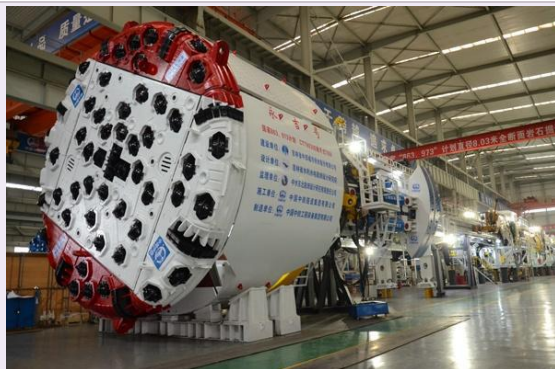
硬岩掘进机（TBM）（国家“863 计划”重点项目）
