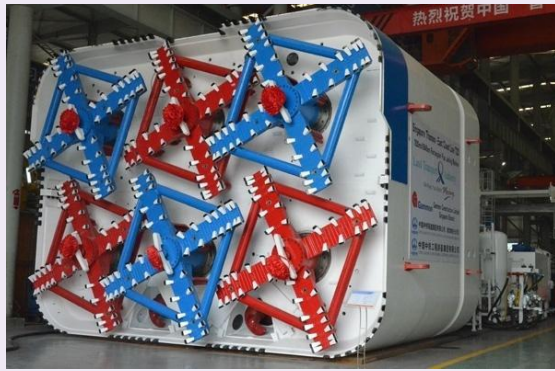
矩形盾构顶管机（新加坡地铁汤申线矩形顶管）
