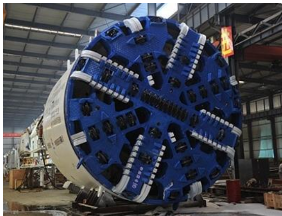
硬岩盾构机（重庆地铁硬岩盾构）
