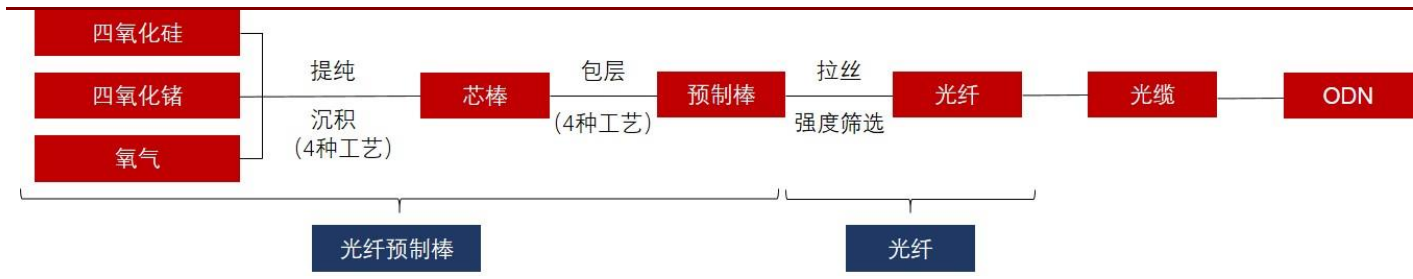
图 8 光棒-光纤-光缆上下游纵向产业链及相关工艺示意图
