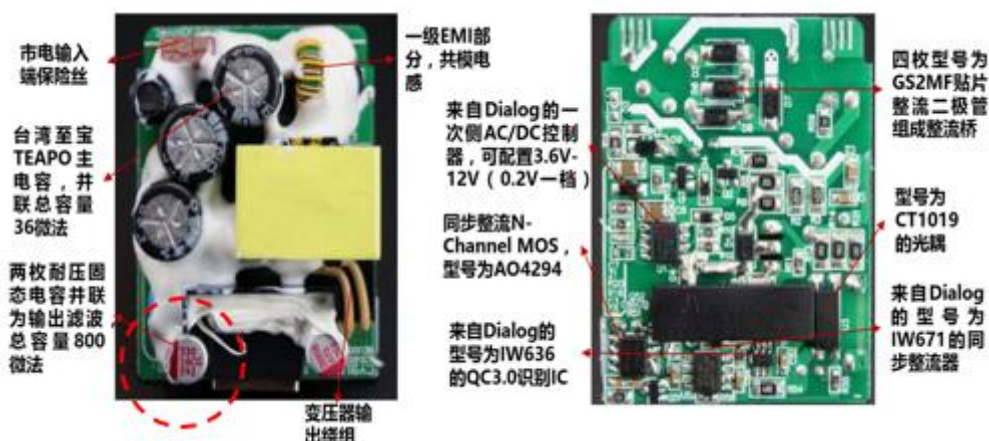
图表 30：固态电容在快充充电器中必不可少
