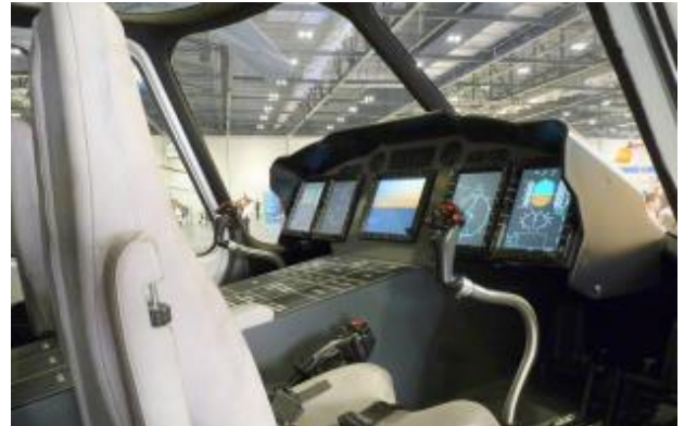
图 18: AC352 采用无机械仪表座舱
