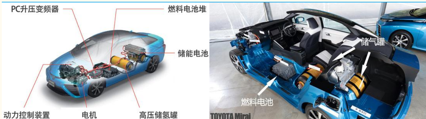
图表 17：丰田 Mirai 燃料电池汽车透视结构图及车载氢气瓶布局
