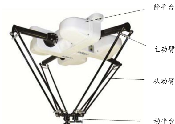
图表33： 并联机器人结构
