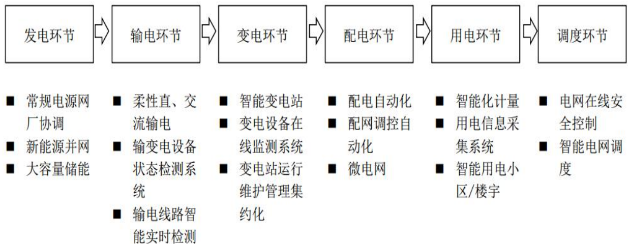
图表 1 智能电网结构图
