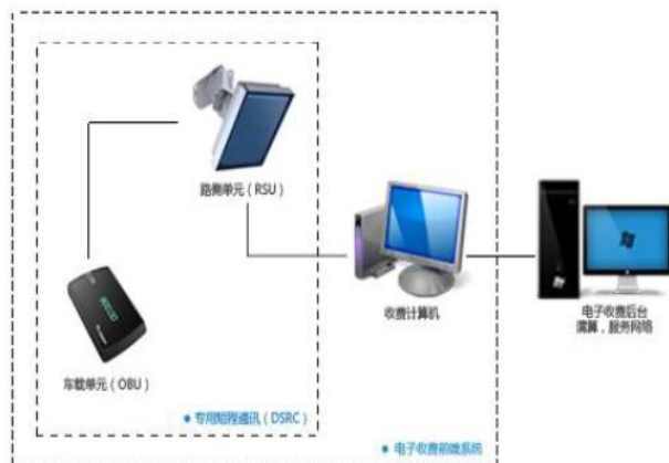
图表15 收费广场式 ETC 系统的系统构成
