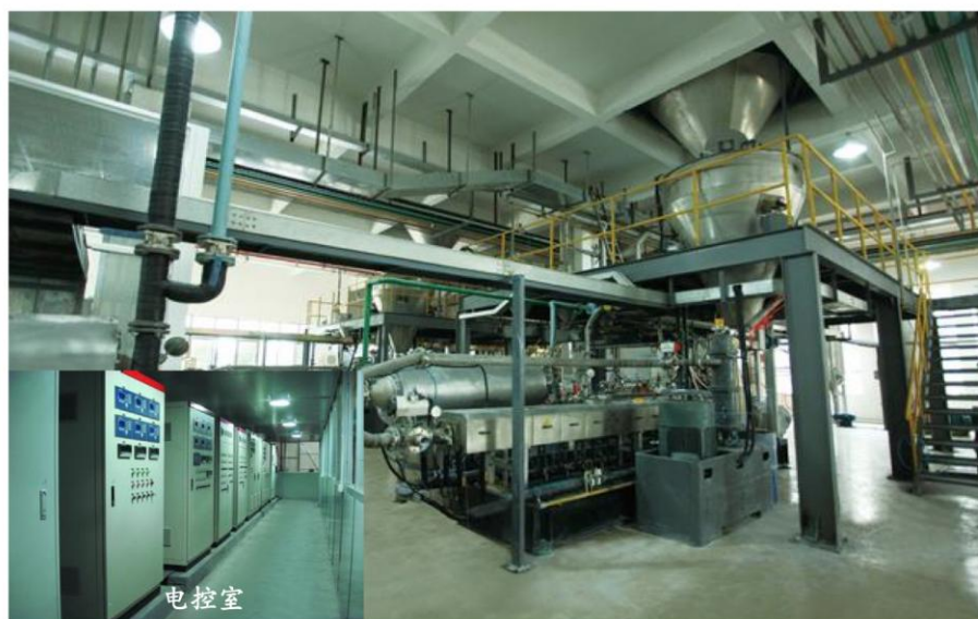
图 4 双螺杆全自动连续生产线局部图
