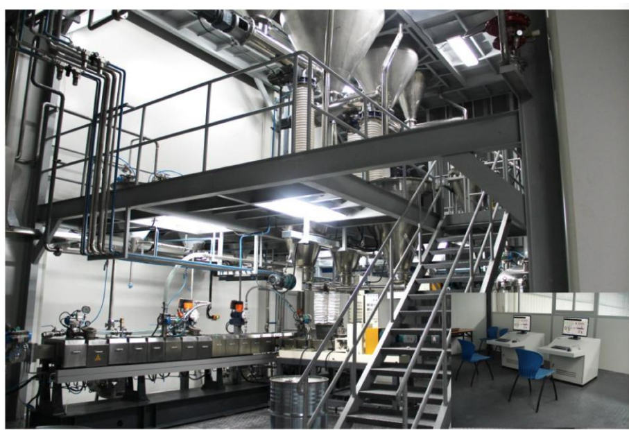
图 6 锂电池浆料全自动双螺杆生产线局部图
