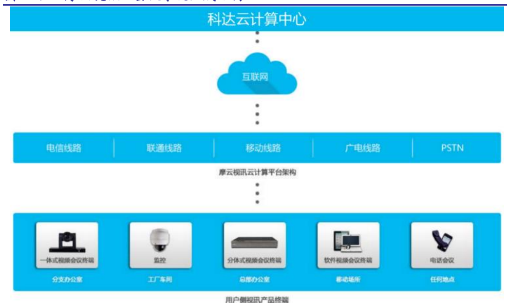
图 17：“摩云视讯”会议系统组成结构
