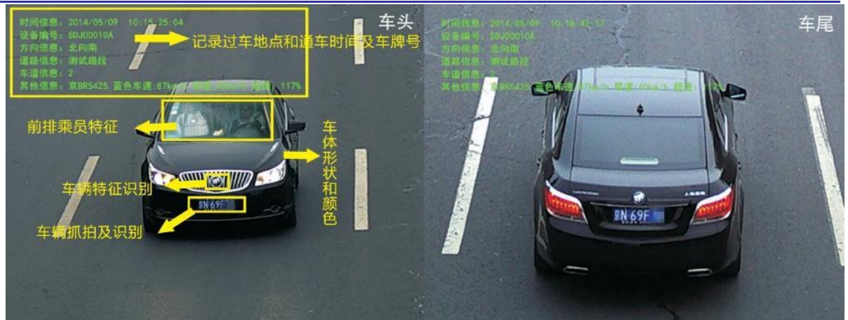
图 32：智能卡口系统自动抓取车辆信息，大幅提升监控效率
