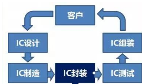
图表 1：芯片封测环节工艺流程
