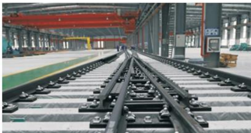
时速 250 公里 60kg/m 钢轨 18 号无砟单开道岔
