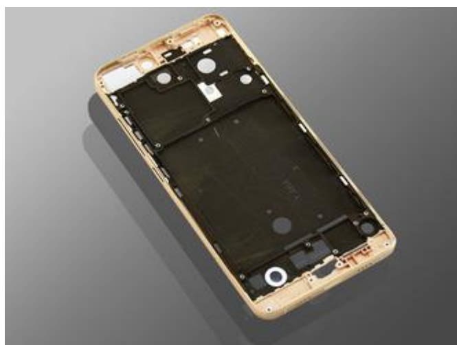
图表30: 中端机壳背面, 内部结构在 CNC 局部加工后, 结合较多注塑
