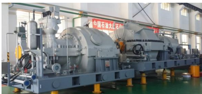
图表 7：新锦化生产的合成氨离心压缩机外观与内部构造
