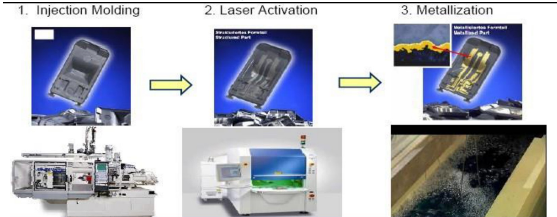
图表 8: LDS (Laser-Direct-Structuring) 激光直接成型生产流程
