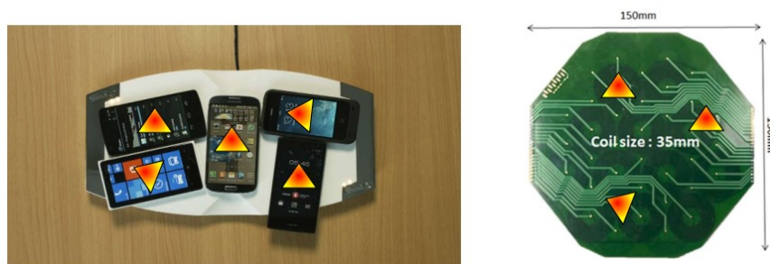
图 60: 可同时充 5 个设备, \Delta 表示热点
