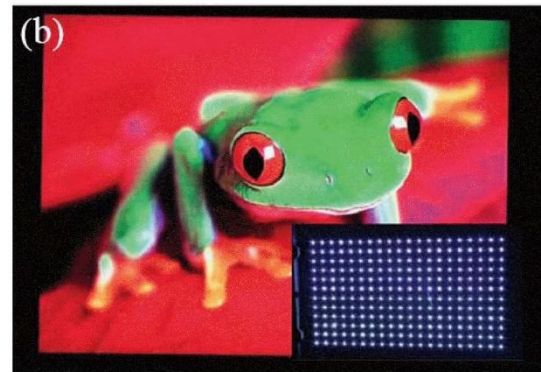
图 13 液晶电视面板和 LED 背光示意图
