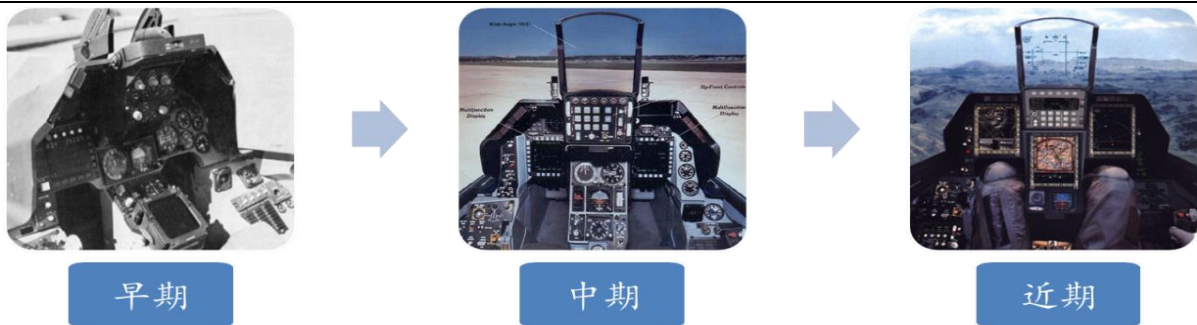
图 21：美国 F-16 战机显控系统升级示意图
