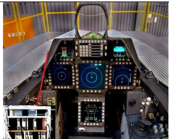
图 22：枭龙战机的图形显控系统采用“一平三下”布局 图 23：美国 F-22 战机的图形显控系统采用“一平多下”布局
