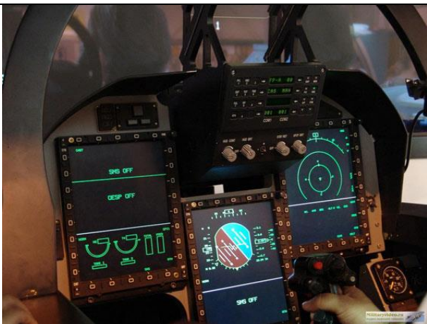
图 22：枭龙战机的图形显控系统采用“一平三下”布局 图 23：美国 F-22 战机的图形显控系统采用“一平多下”布局
