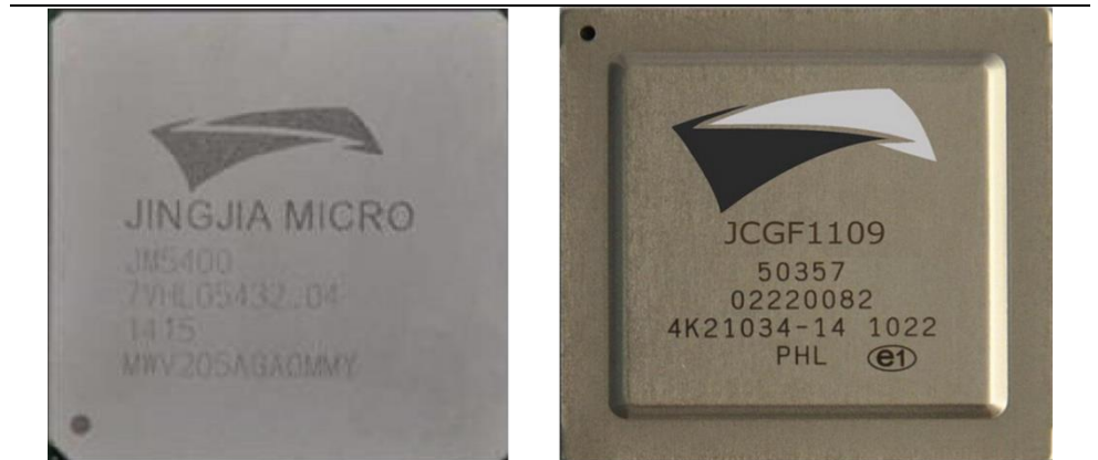
图 36: 弹载图形处理芯片 GPU JM5400 和 JCGF1109
