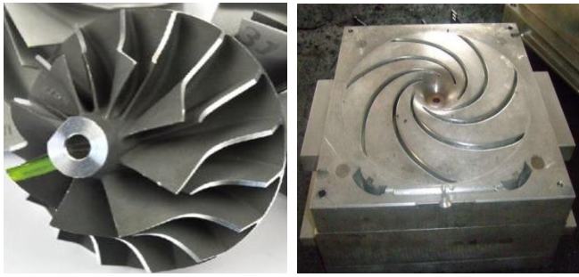
图 10: 传统铸造成型叶轮及模具
