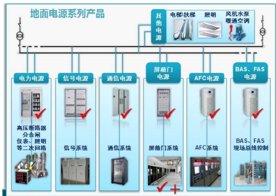
图 27：公司地面电源覆盖信号电源、通信电源、屏蔽门电源等
