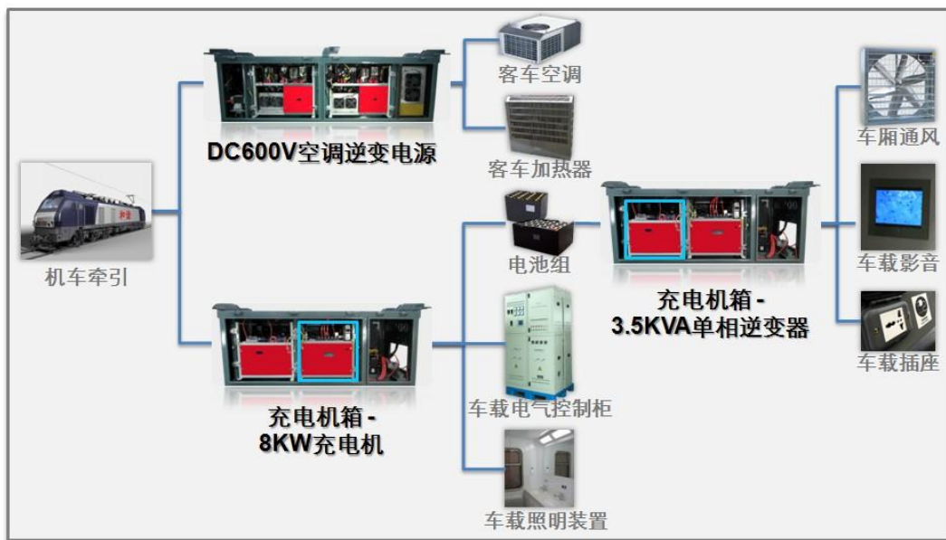
图表 36：公司 DC600V 空调逆变电源
