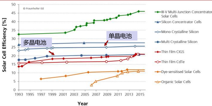
图 18: 单晶电池效率整体高于多晶电池
