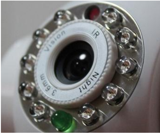
图表32: 夜视功能安防摄像头的 IR LED 光源示意图
