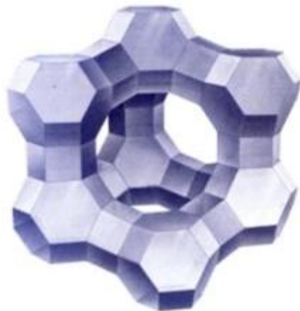
图 7: 沸石分子筛内部结构图
