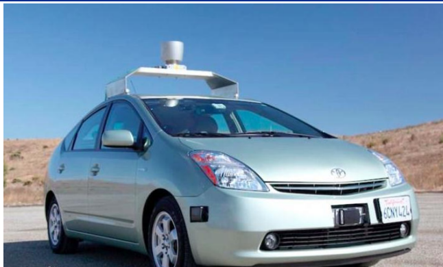
图 23: Google 无人驾驶汽车车顶的旋转式激光测距仪
