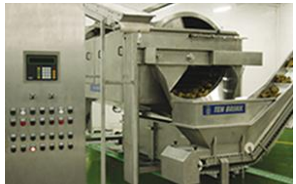
图 10：净化水滚筒旋转式喷淋清洗机代替人工清洗
