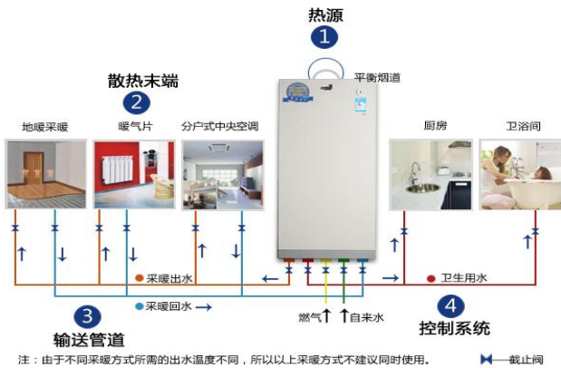
图 6：壁挂炉管道图示
