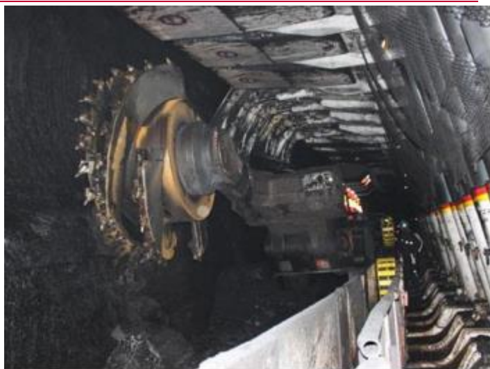
图表 7：公司研制的国内首套综采工作面成套装备智能化系统
