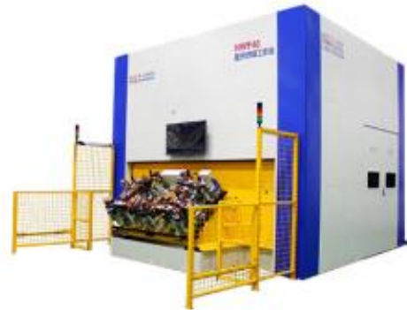
图 3：汽车车身覆盖件激光焊接工作站
