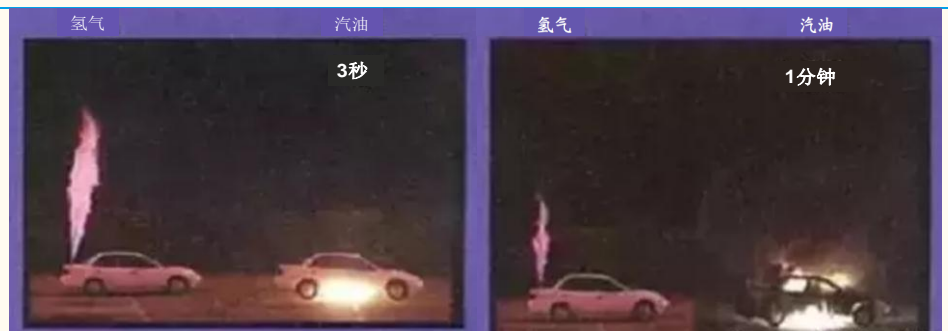
图表 23：储氢瓶泄露点火试验
