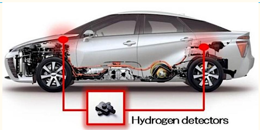
图表 17: Mirai 氢气传感器分布示意图
