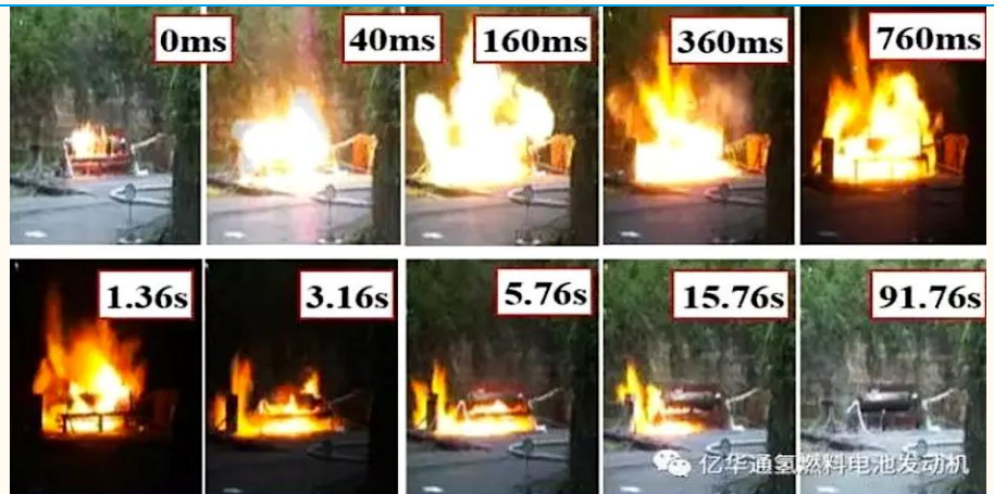
图表 22：储氢瓶火烧试验
