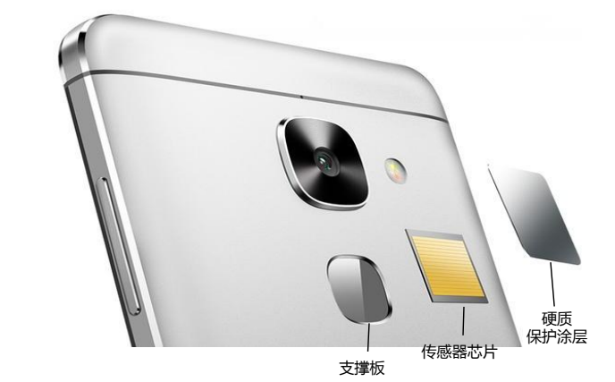
图47: 后置涂层式指纹识别模组结构
