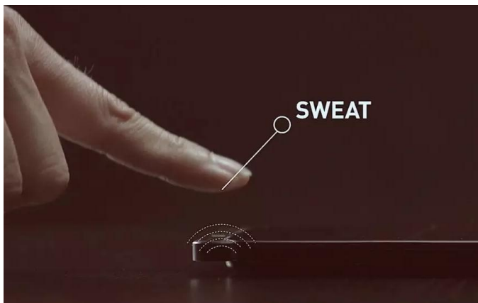
图46: 超声波指纹识别可以穿透表皮层
