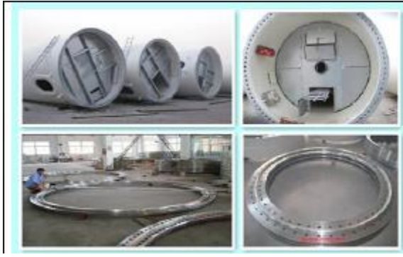
图 1：以风电塔筒法兰为主的辗制环形锻件
