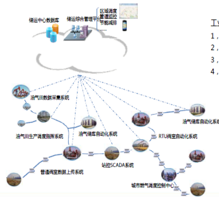
图表 26：东土科技油气储运监控系统
